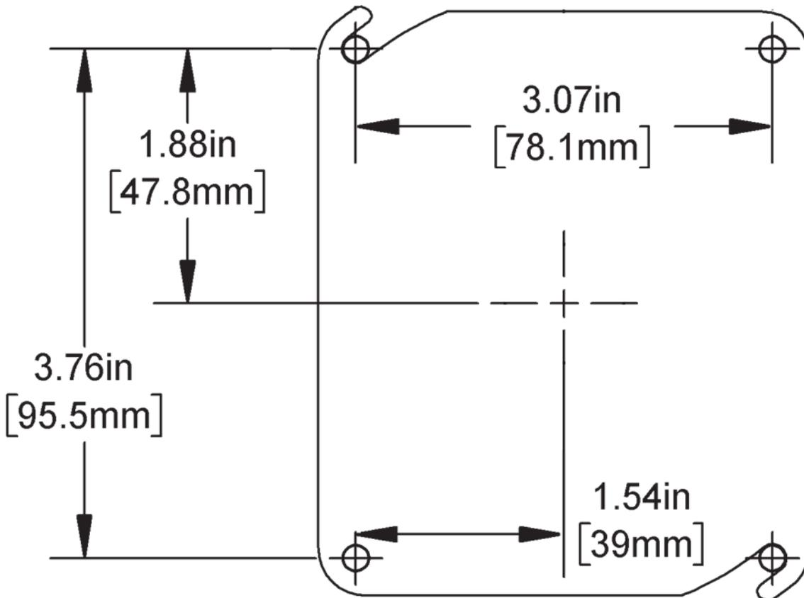
Figure 5: Mounting Hole Template - shown actual size
